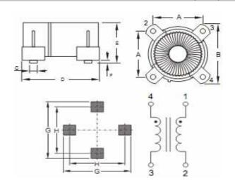
$\begin{array}{lll} \textbf{A} & 10.2 \pm 0.25 \\ \textbf{B} & 13.5 \pm 0.25 \\ \textbf{C} & 3.2 \pm 0.25 \\ \textbf{D} & 12.4 \pm 0.25 \\ \textbf{E} & 7.87 \text{ max} \\ \textbf{F} & 1.02 \text{ max} \\ \textbf{G} & 17.4 \\ \textbf{H} & 14.35 \\ \end{array}$
