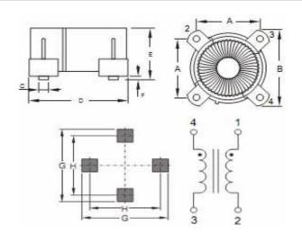
A  $10.2 \pm 0.25$ B  $13.5 \pm 0.25$ C  $3.2 \pm 0.25$ D  $12.4 \pm 0.25$ E 7.87 max F 1.02 max G 17.4H 14.35
